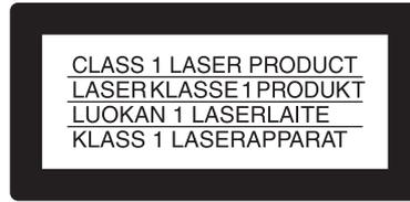
Dieses Modell (HVO-3300MT) ist als LASERPRODUKT DER KLASSE 1 eingestuft. (IEC 60825-1: 2007 und IEC 60825-1: 2014)
